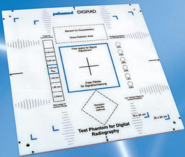
Mit dem von pehamed gefertigten Prüfkörpersystem für die Digitale Radiographie "DIGRAD" sind die von der DIN 6868/58 und DIN 6868/13 geforderten Prüfungen des Dynamikumfangs, der Kontrastauflösung, der Homogenität der Aufnahme und der Ortsauflösung von Röntgenanlagen mit digitalem Bildempfängersystem möglich.
